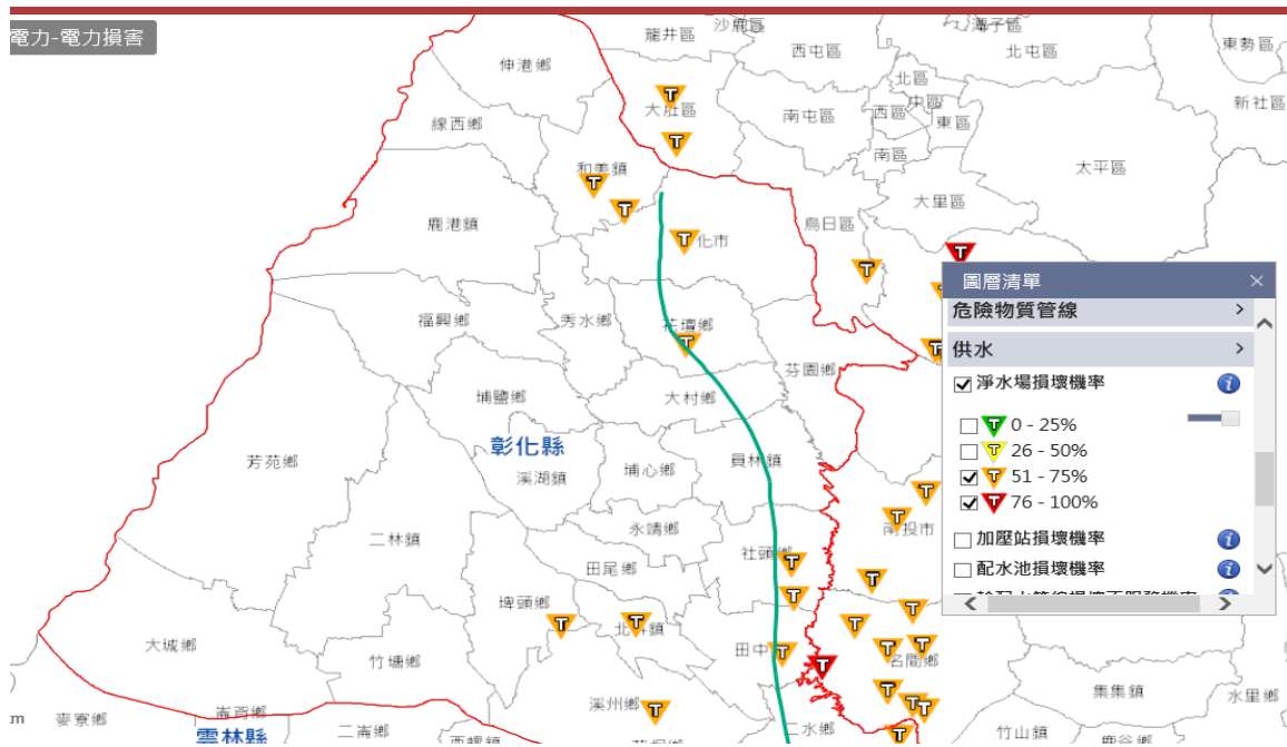
圖 1-3-10 模擬淨水廠損壞機率
